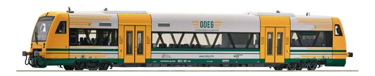
Diesel railcar class 650 of the Ostdeutsche Eisenbahn GmbH.
